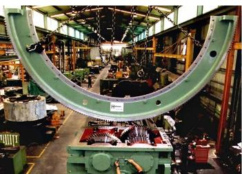
SELF ALIGNING, TWIN PINION MILL DRIVE GEARBOX
