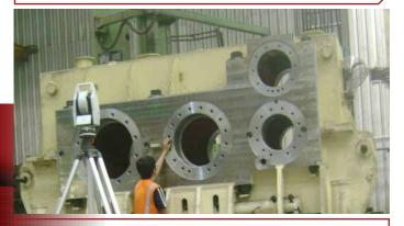
LASER TRACKER ON A GEARBOX CASING
