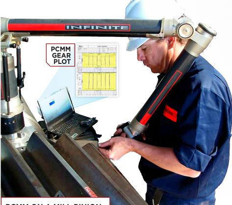
PCMM ON A MILL PINION
